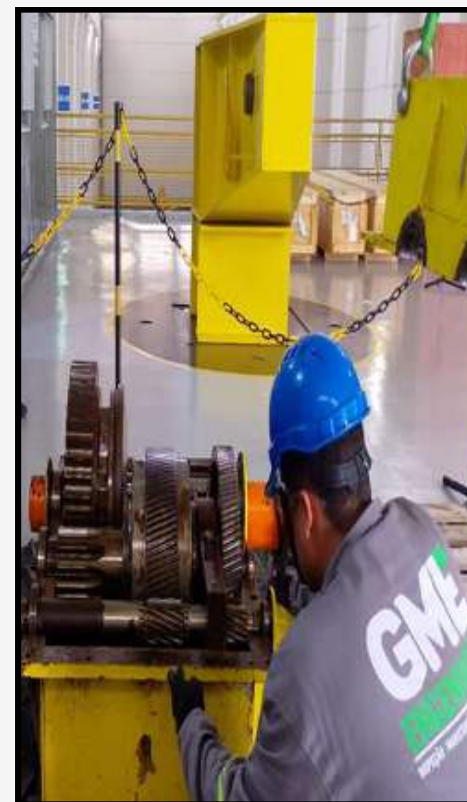
Revisão e Montagem de Redutores
